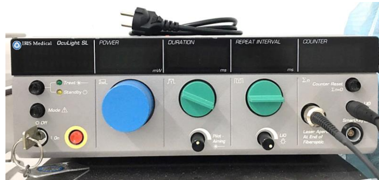
Hình 2-11: Máy LASER diode 810nm tại Bệnh viện Mắt TP.HCM
