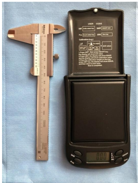
Hình 2.7. Thước cặp và cân điện tử đã được hiệu chuẩn
